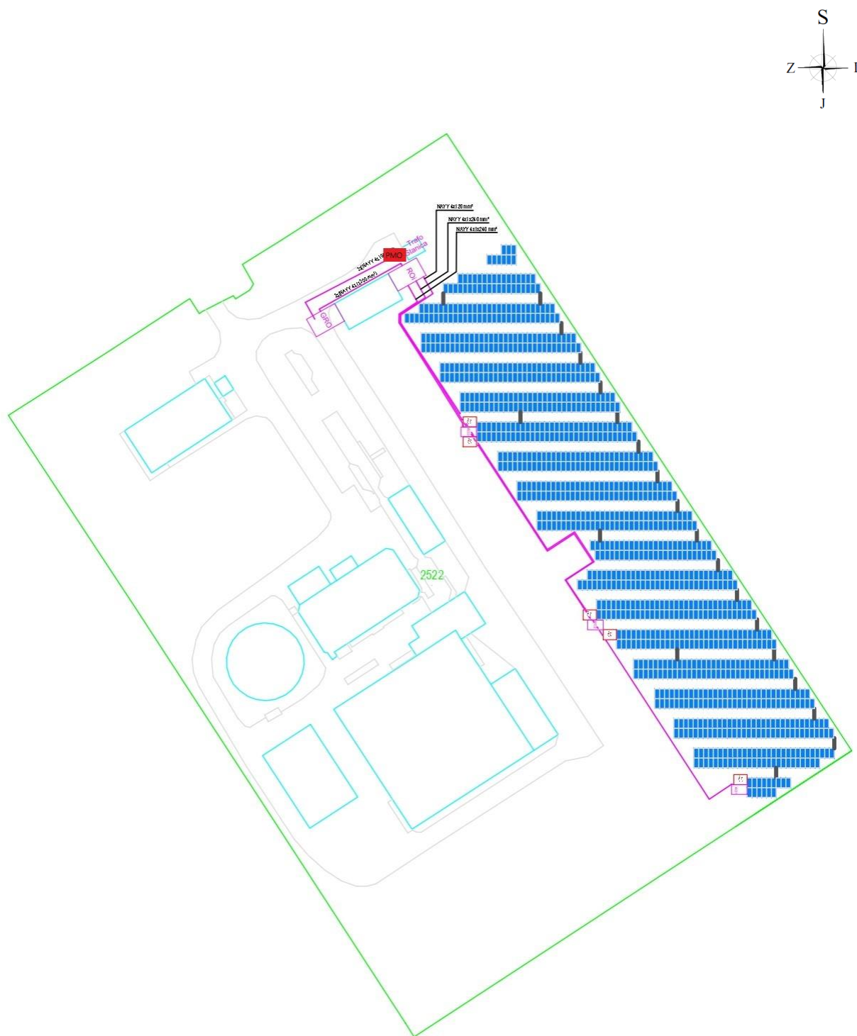
Grafički prikaz 3-2: Prostorni raspored elemenata elektrane Izvor: Idejni projekt
